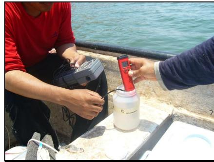
**Figuras 3 y 4.** Análisis de la transparencia, medición de pH, temperatura y oxígeno disuelto.
