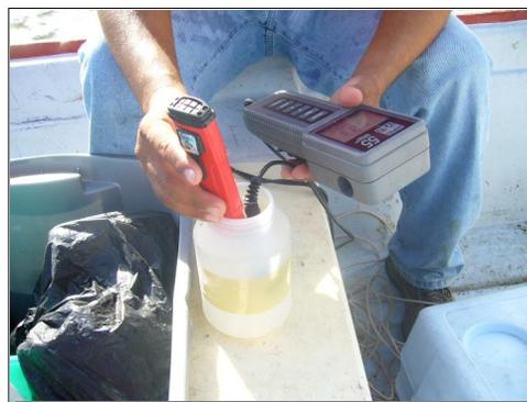
**Figuras (3, 4).** Análisis de la transparencia, medición de pH, temperatura y oxígeno disuelto.
