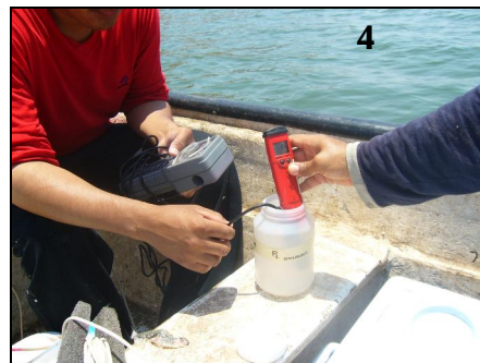
Figuras (3,4). Análisis de la transparencia (3), medición de pH, temperatura y oxígeno disuelto (4).
