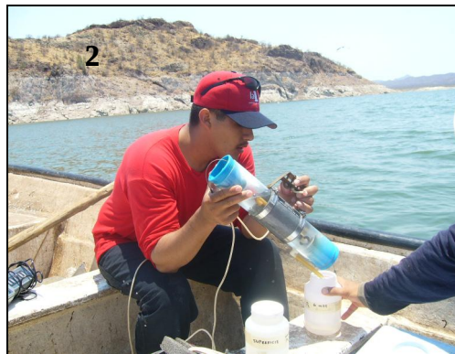
Figuras (1,2). Recolección de muestras con botella Van-Dorn para el posterior análisis de calidad de agua.
