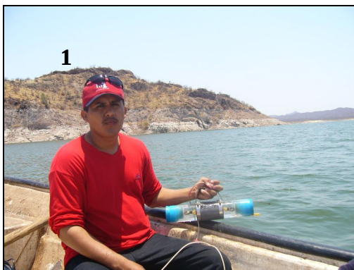
Figuras (1,2). Recolección de muestras con botella Van-Dorn para el posterior análisis de calidad de agua.
