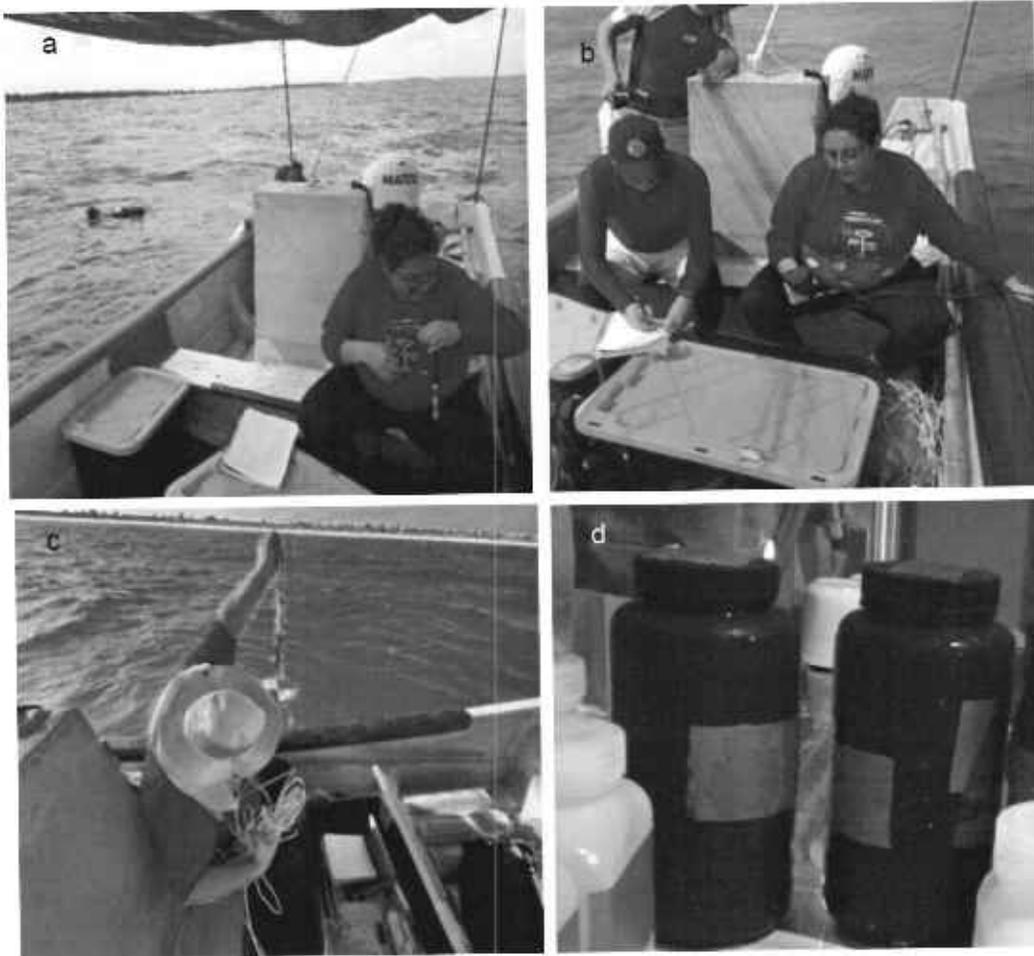
Figura v. Toma de parámetros fisicoquímicos de la columna de agua en El Cuyo. a) uso de la sonda multiparamétrica YSI, b) lectura de temperatura con el multiparámetro, c) medidas de luz con el disco de Secchi, botellas ámbar para colecta de agua. Fotos: Laboratorio de Producción Primaria
