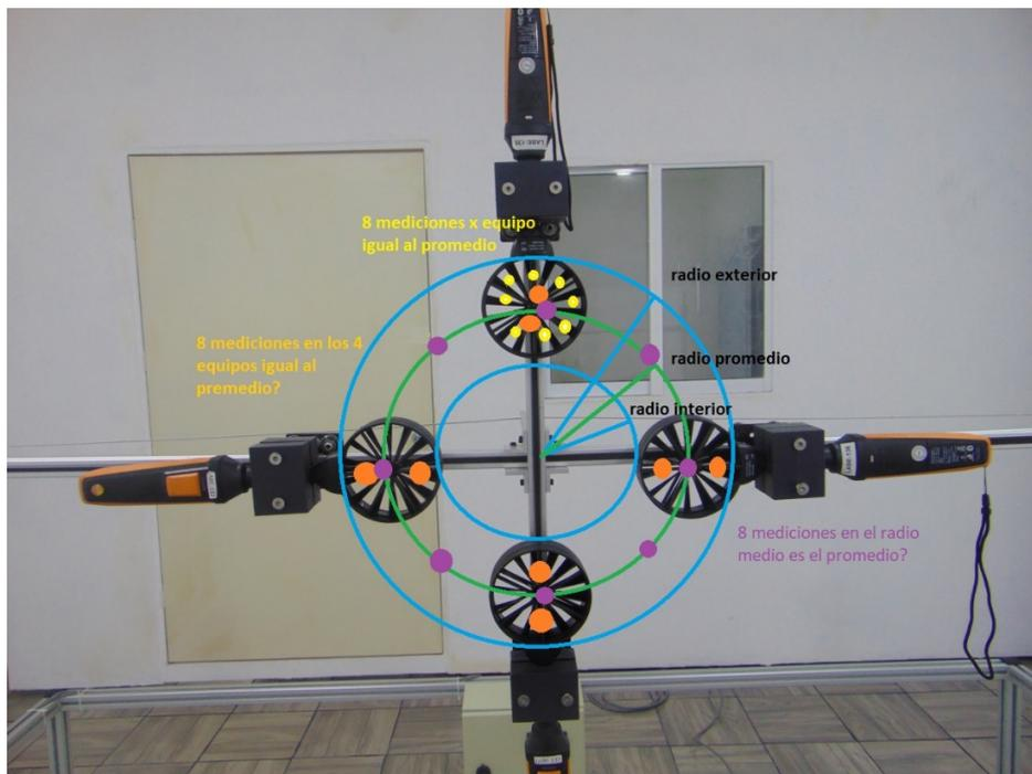
La velocidad promedio del aire a través de **cada anillo es el promedio de las 8 velocidades del aire** obtenidas en cada posición del anemómetro tomadas en el eje horizontal y en el eje vertical en cada uno de los radios interior y exterior del anillo. **El radio medio de cada anillo es igual al promedio de los radios interior y exterior del anillo.** Las velocidades promedio del aire por debajo de 0,24 m/min son descartadas.
