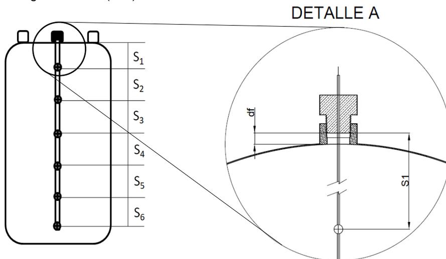
**Figura 2 – Diagrama del arreglo de sensores (Ilustrativa).**
