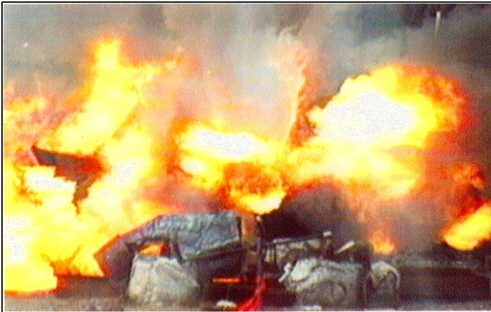
**Figura 6.4 BLEVE (lento en un paso) en un tanque de gas LP (Birk,2000).**
