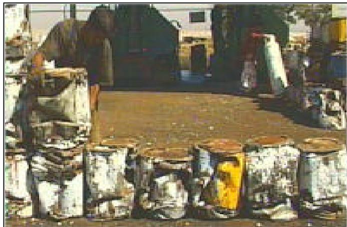
**Figura 5.7 Cilindros de gas LP destruidos**
