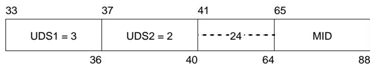
4.3.8.4.2.3.4 *Subcampos de MU para una radiodifusión de RA.* Si UDS1 = 3 y UDS2 = 1, MU constará de los subcampos siguientes:
