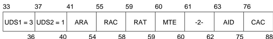
4.3.8.4.2.4 *Campo MV.* Este campo de 56 bits (33-88) de respuestas de vigilancia larga aire-aire (Figura 4-1) se utilizará para transmitir mensajes de respuesta de coordinación aire-aire.
