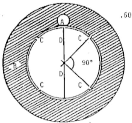
Figura A.1.- Vista de planta de una plataforma completa y puertos para muestreo.
