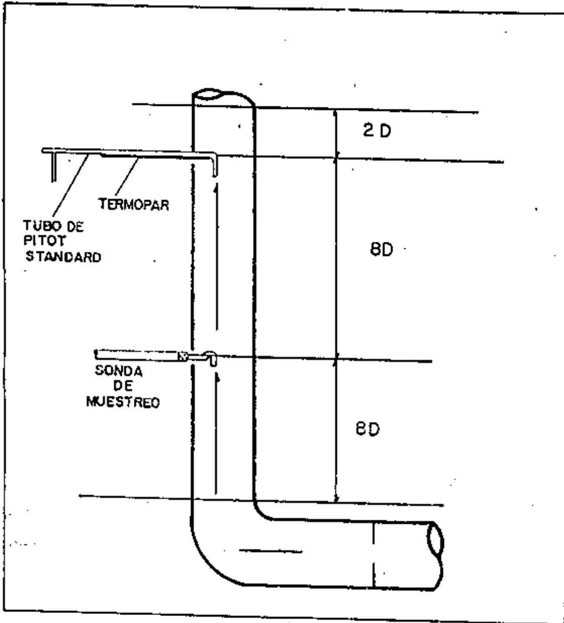
Figura B.2.- Disposición de pitot y sonda de muestreo en ductos de 10 a 30 cm (3.94 a 11.81 in).
