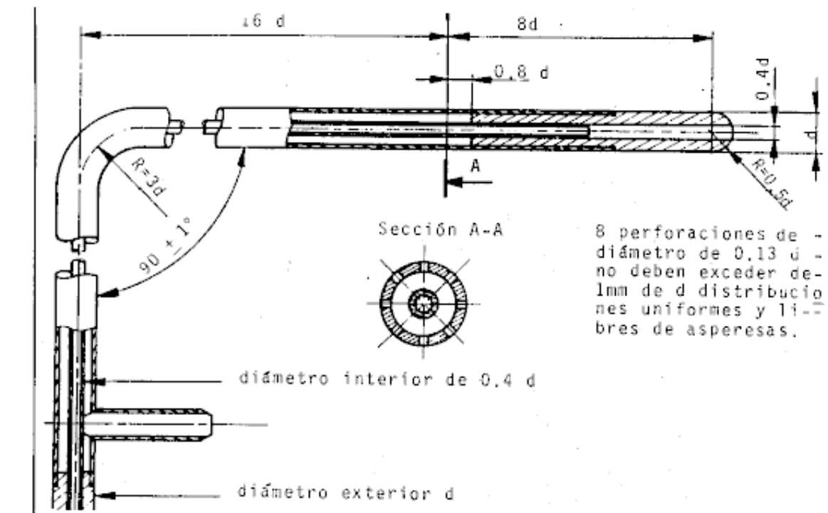
FIGURA 1.- TUBO DE PITOT – TIPO “AMCA”
