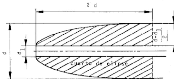
Detalle de la boquilla elipsoidal modificada
