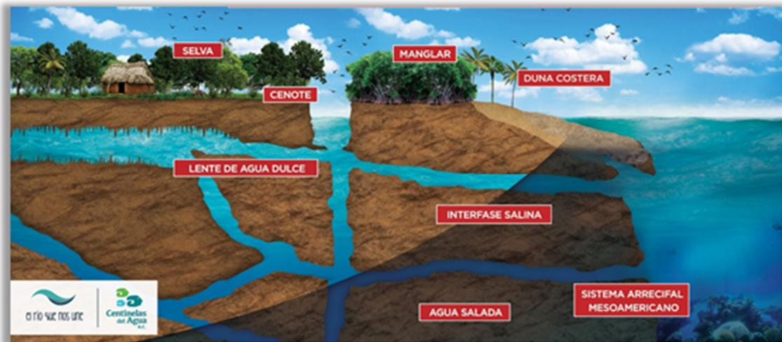
**Figura 1.** Esquema representativo del espesor del lente de agua dulce e interfase salina. Se resalta la presencia de conductos de disolución (ríos subterráneos) con conectividad desde la selva hasta el mar (Centinelas del Agua AC 2017).
