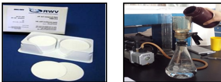
Figura 4. a) Filtros de fibra de vidrio GF/F 0.7 µm b) Filtrado de muestras para la determinación de MOP y SST
