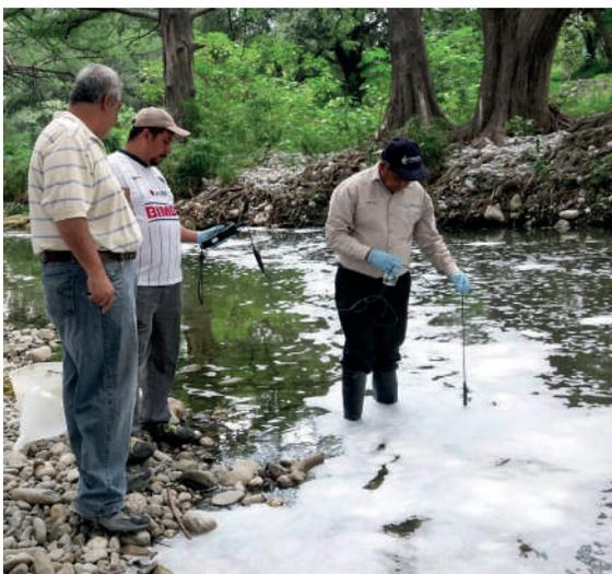
*Toma de muestra en un cuerpo de agua para verificar niveles de contaminación*
