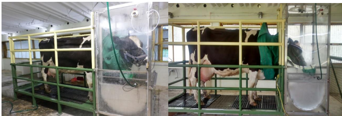
Imagen 4. Caja de cabeza del Laboratorio de Ganadería, Medio Ambiente y Energías Renovables de la Universidad Autónoma del Estado de México
