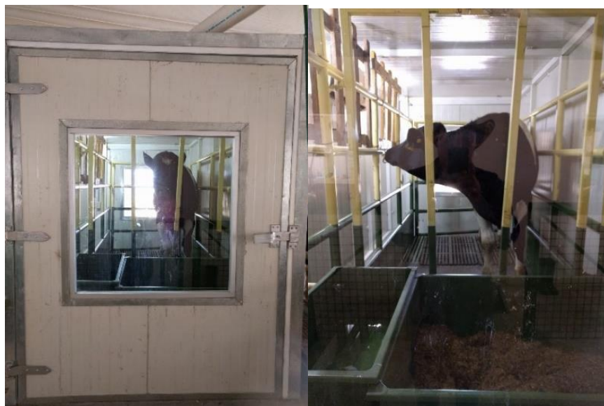
Imagen 3. Cámara de respiración de circuito abierto del Laboratorio de Ganadería, Medio Ambiente y Energías Renovables de la Universidad Autónoma del Estado de México
