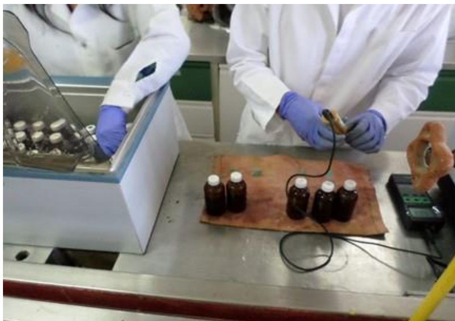
Imagen 2. Técnica de producción de gas in vitro
