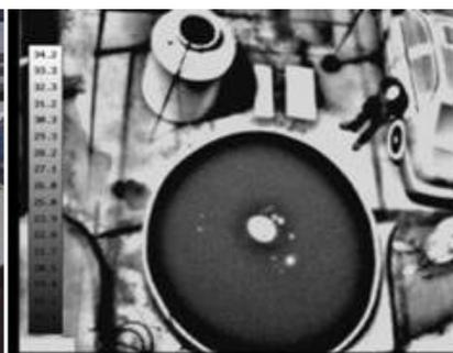
Figura 20b. El diámetro de la marca ,es de 0.41m, diferencial de temperatura es de 12°C aprox.
