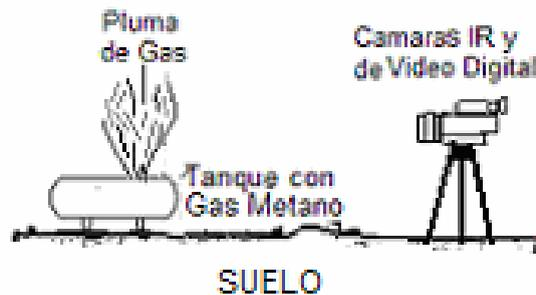
Figura 5.12. Sistema para simular fugas de gas metano en campo.
