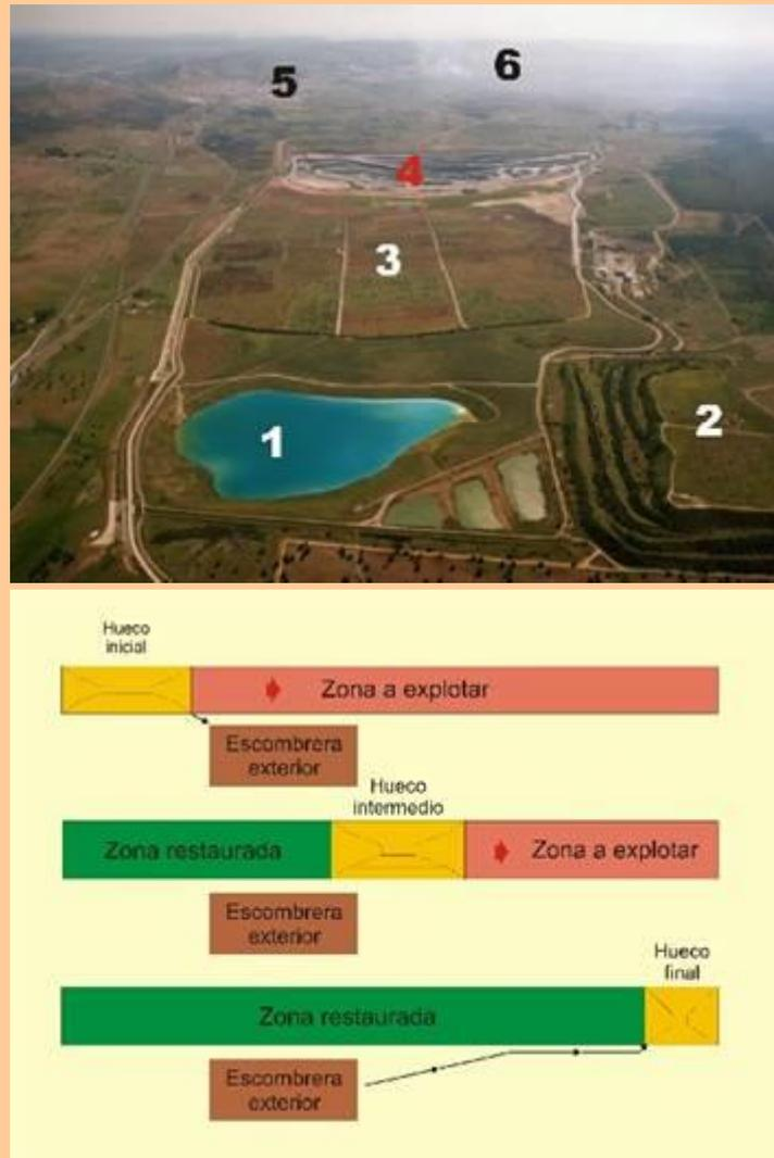
Figura 1.- Restauración de la mina Emma, descubierta para carbón localizada en Puertollano (Ciudad Real, España).
