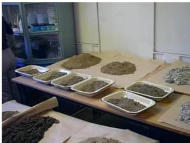
Foto 4.- Muestras de geoquímica dispuestas para su secado.
