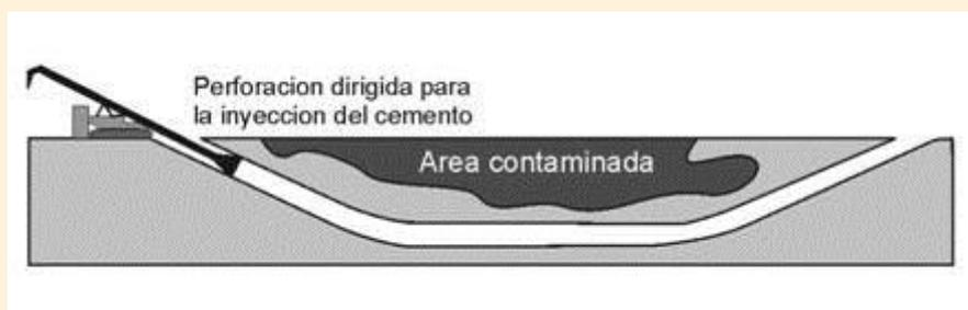
Figura 3.- Esquema del proceso de inyección de lechada de cemento bajo una mancha de contaminación.
