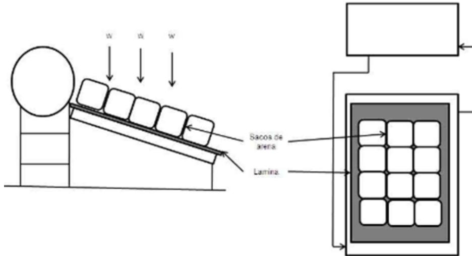
**Figura A 9 - Resistencia a la presión positiva**
