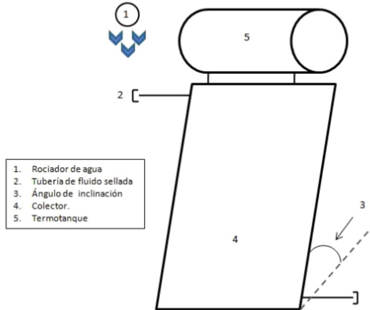
**Figura A 7 - Penetración por lluvia**
