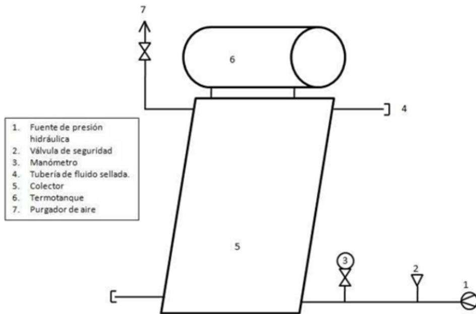
**Figura A 11 - Resistencia al sobrecalentamiento**
