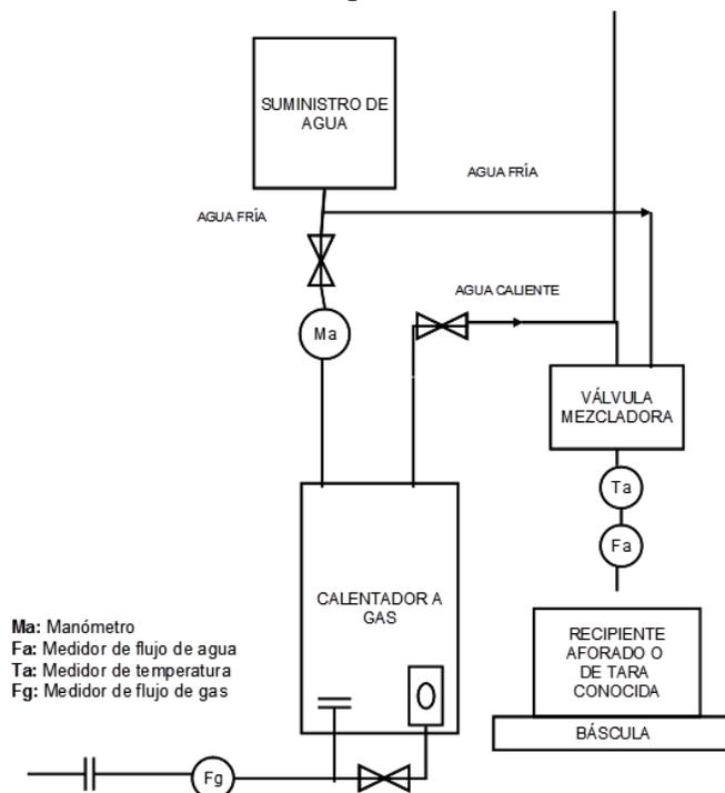
**Figura A 3** Esquema de instalación para medir el consumo de gas del calentador de referencia.
