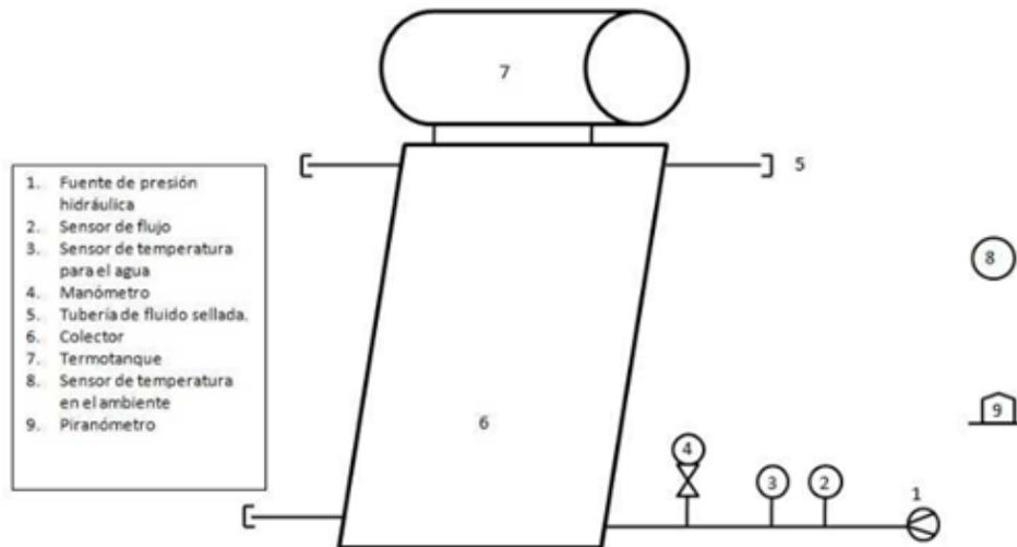
**Figura A 10 - Resistencia a la presión hidrostática**
