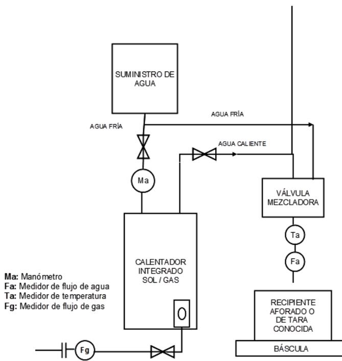
**Figura A 2** Esquema de instalación para medir el consumo de gas de un calentador de agua solar y un calentador de agua a gas, integrados.
