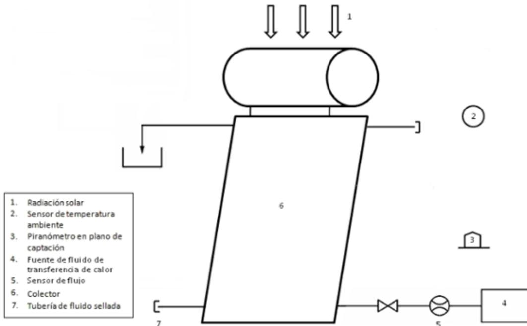
**Figura A 8 - Choque térmico interno**
