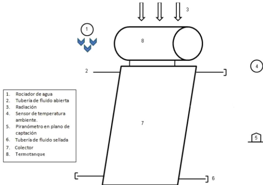
**Figura A 6 - Choque térmico externo**
