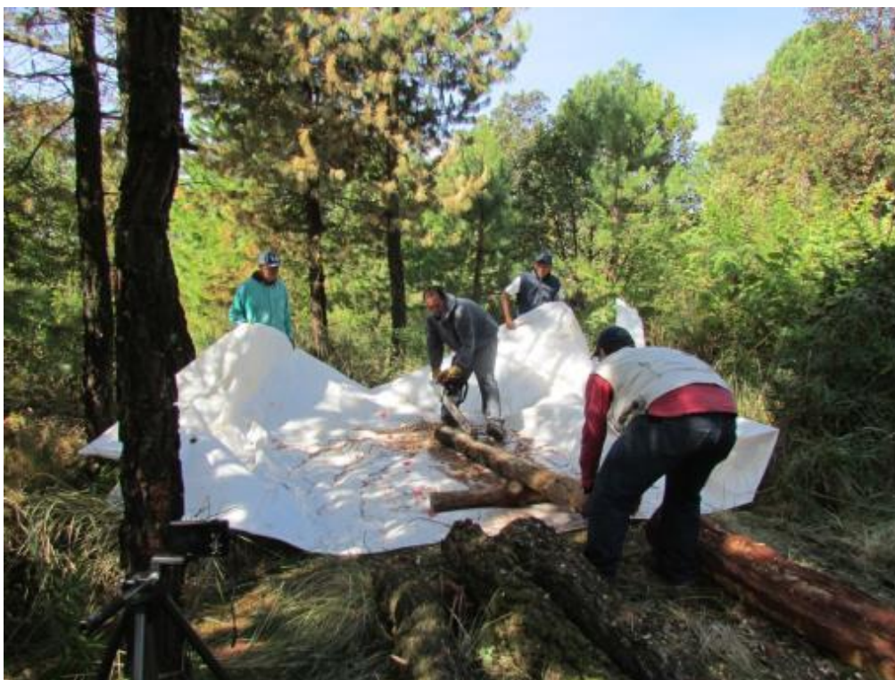
Figura 2.- Troza siendo descortezada con el Log Wizard y todo el resultante en el plástico de poliuretano
