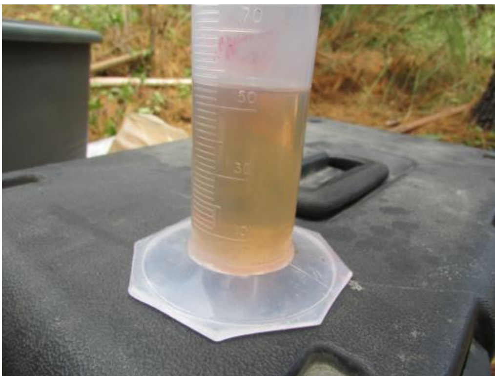
Figura 13.- Medición de consumo de combustible por el equipo.
