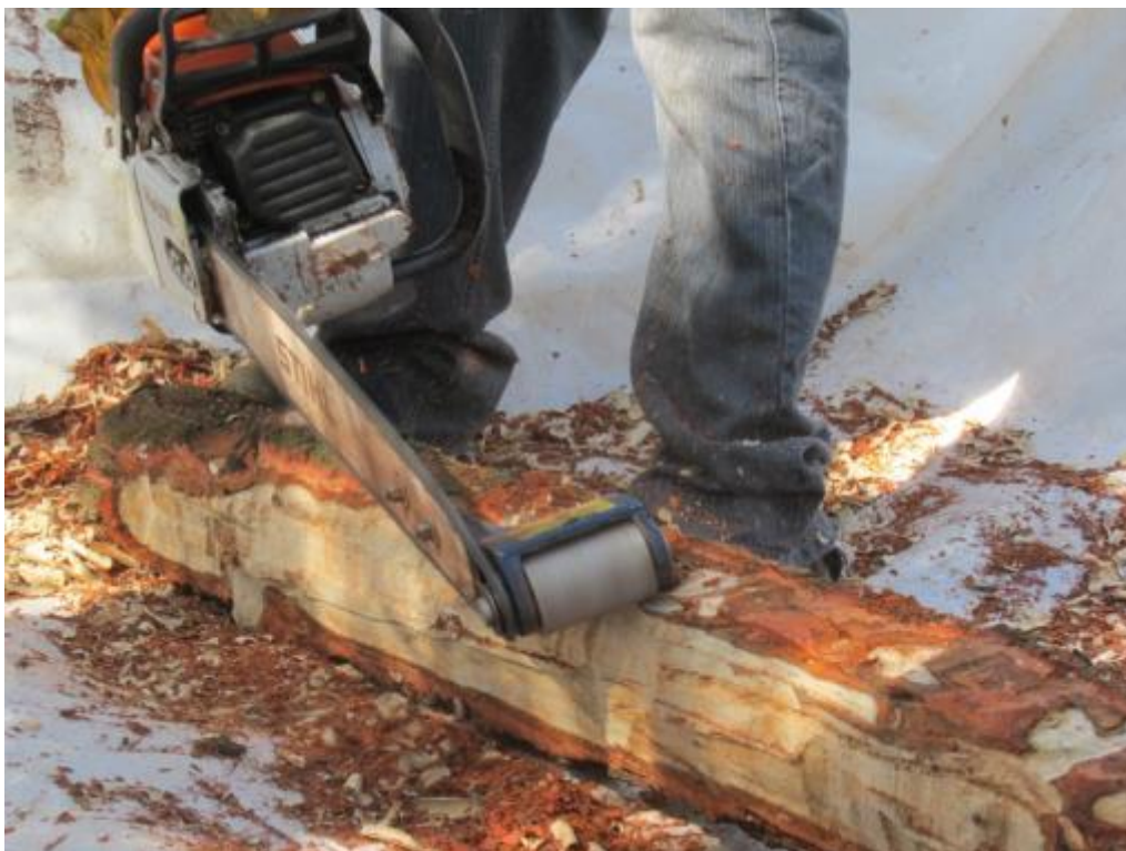
Figura 3.- descortezado de troza con el equipo Log Wizard
