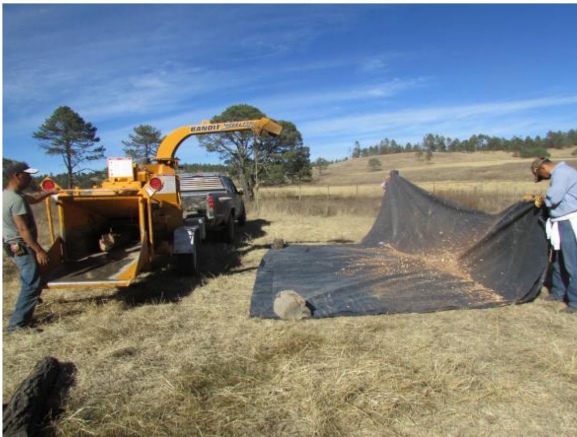
Figura 16. Preparación del sitio para el uso de la astilladora
