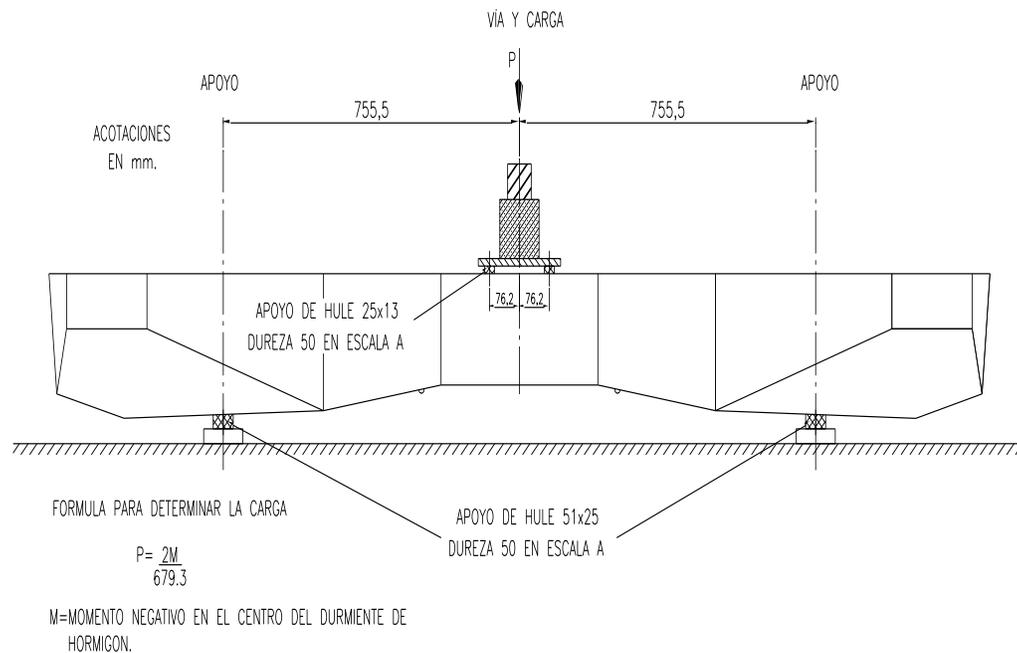
**Figura 3. Prueba de momento Negativo en el centro del durmiente.**
