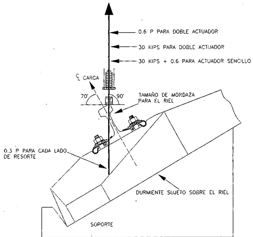
**Figura 7. Prueba dinámica en la fijación.**
