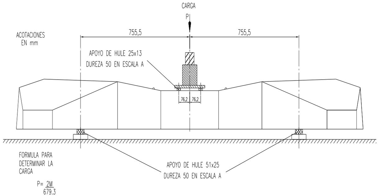
**Figura 4. Prueba del momento positivo en el centro del durmiente.**
