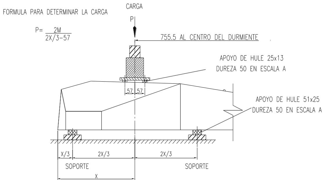
**Figura 2. Prueba del momento positivo en el asiento del riel**
