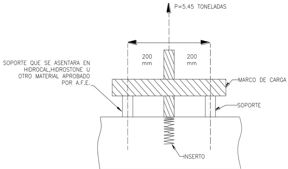
**Figura 5. Prueba en el inserto de la fijación.**
