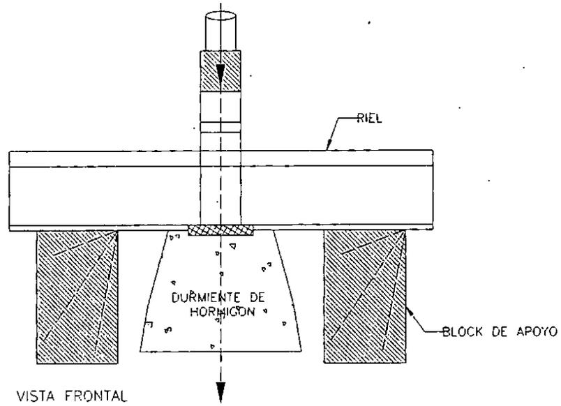
Figura 6. Prueba de levantamiento de la fijación.
