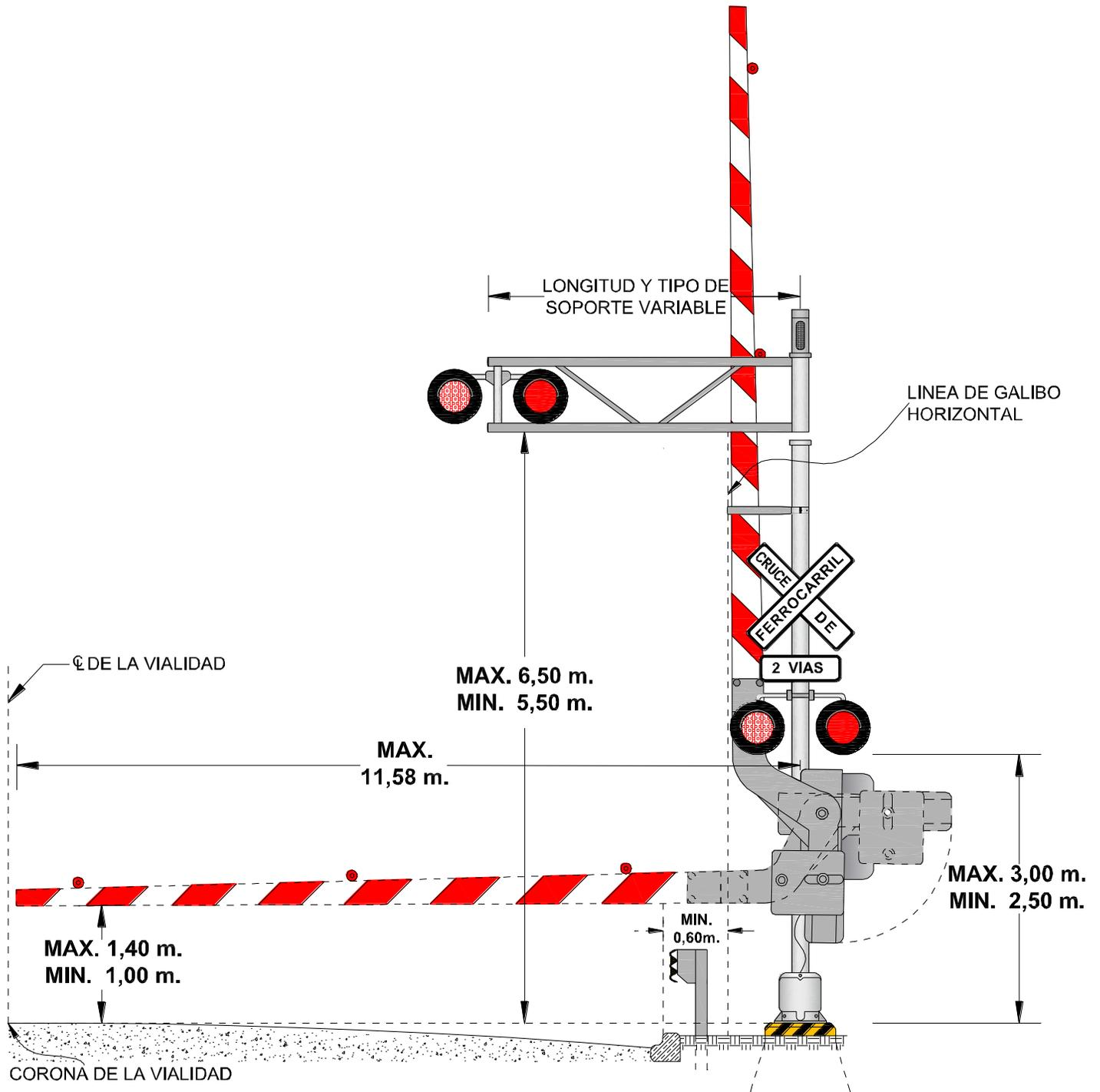
Figura 9. Especificaciones generales del señalamiento activo.
