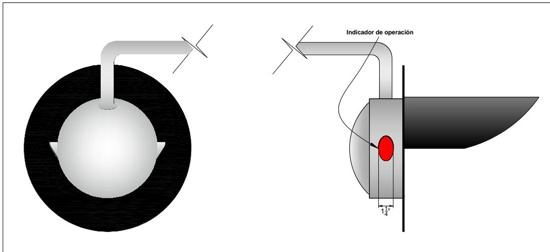
**Figura 8.** Detalle de indicador de operación.
