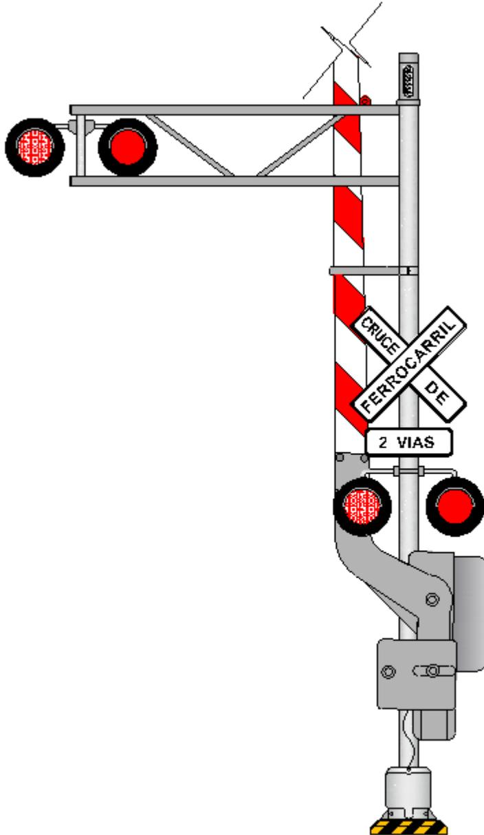
**Figura 6.** SEM-4.6A con unidades de destello adicionales en soporte tipo ménsula.
