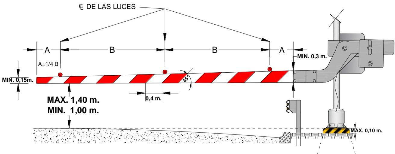
**Figura 10.** Detalle del diseño de la barrera.
