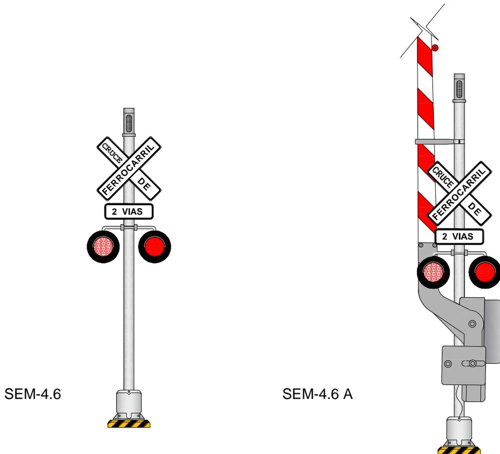
**Figura 4.** Semáforos y barreras para indicar la aproximación de equipo ferroviario.
