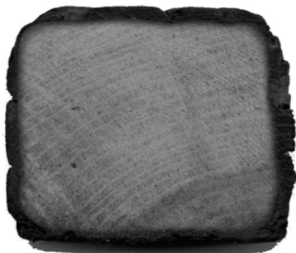
Figura 1. Sección de un polín de madera carbonizado en su exterior por un incendio, pero íntegro en el interior, debido a la baja conductividad térmica (Foto: M. Fuentes)
