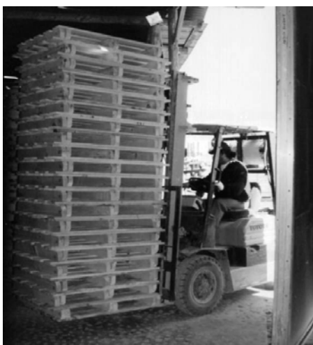
Figura 27. Cargador frontal (montacargas) para movimiento del embalaje
