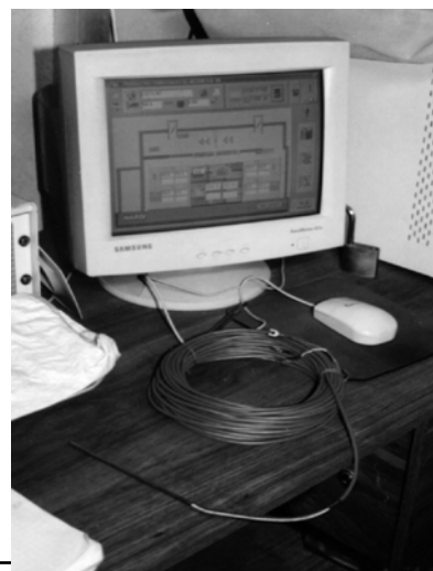
Figura 23. Sistema computarizado para control y registro de variables en la cámara de tratamiento.
