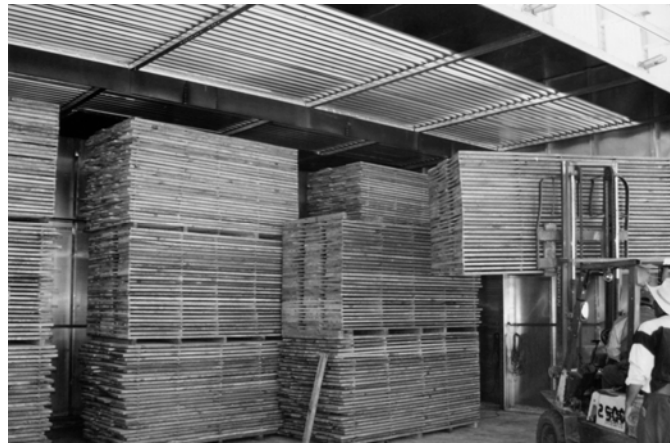
Figura 30. Cámara de tratamiento térmico y secado tipo compartimento, para carga lateral con montacargas.
