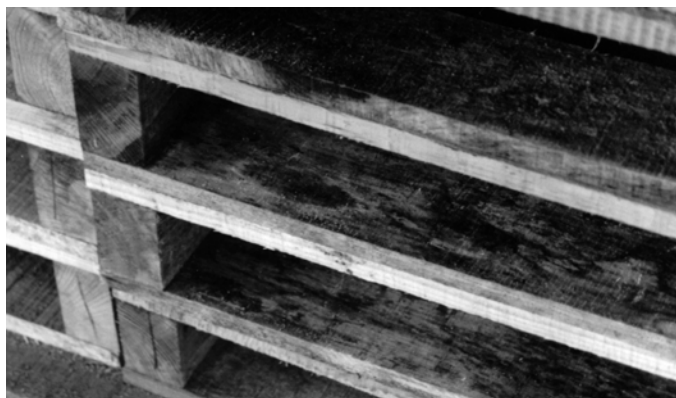
Figura 6. Tarima de madera de encino y pino verdes, manchada por hongos cromógenos. (Foto: M. Fuentes)
