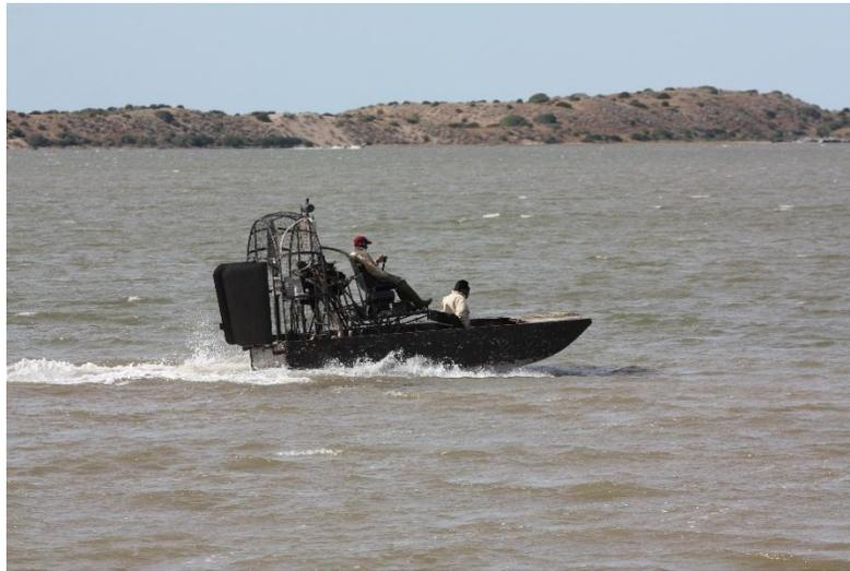
Figura 13. Aerobote de cazadores en Bahía Tóbari. Su escaso calado le permite navegar prácticamente en lodo.
