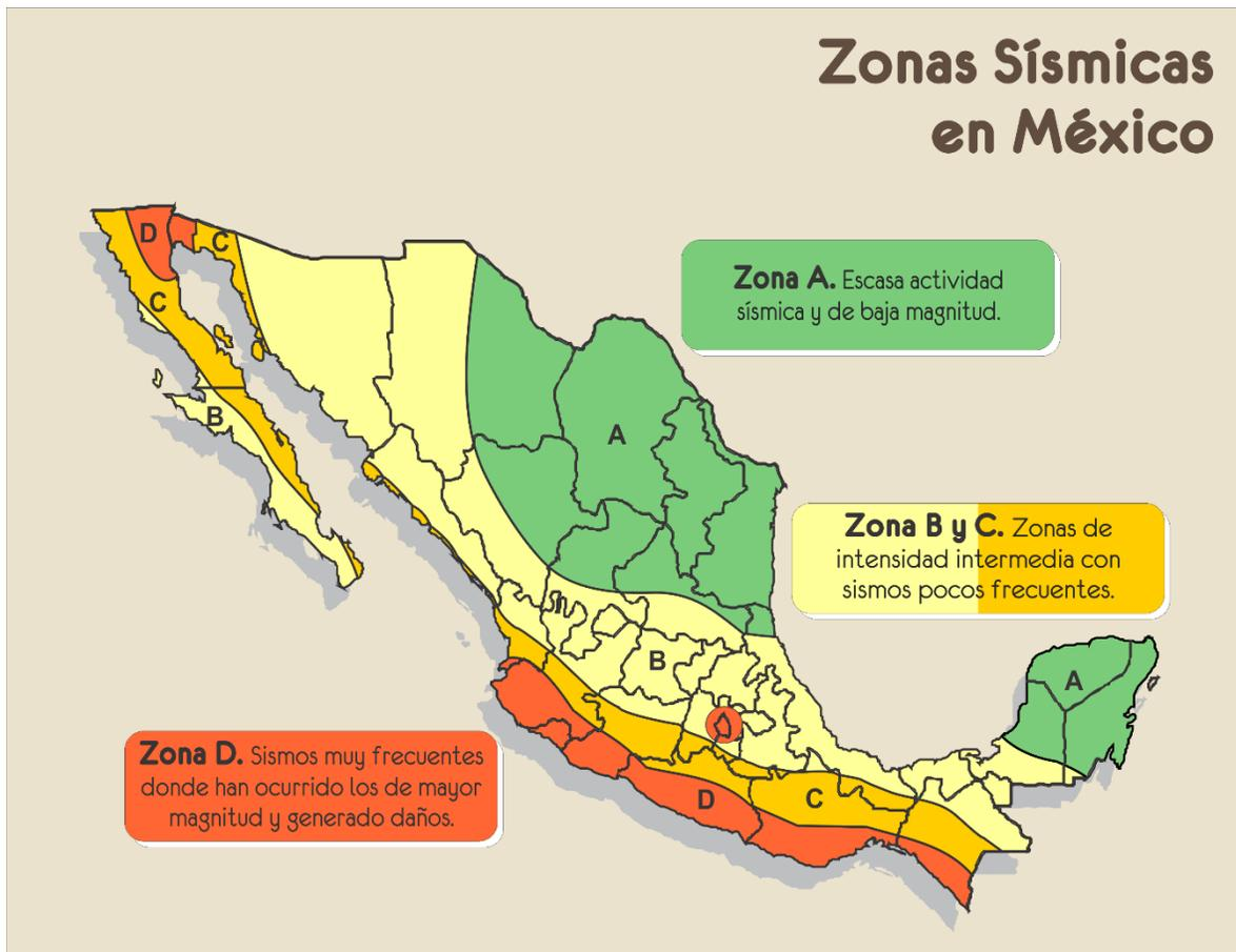
Figura 6. Zonas sísmicas de la República Mexicana (tomado de: <https://blogcires.mx/tag/zonas-sismicas-en-mexico/>).
