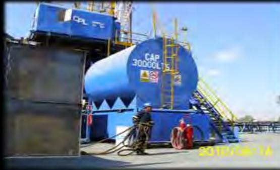
**4.3.3.** El sistema de potencia del equipo de perforación está integrado por cuando menos tres motores principales de combustión interna diesel, para lo cual se requieren dos tanques de almacenamiento de combustible de 30 000 litros c/u.
