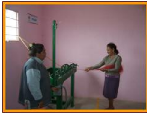
Fotografía . Hiladora con capacidad para cinco personas, se programan para aprovechar las cinco poleas e hilar todas a la vez, esto para ahorrar energía eléctrica.
