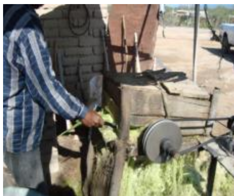
Fotografía Implementación tecnológica para el tallado mecánico para la obtención de ixtle de lechuguilla en greña
