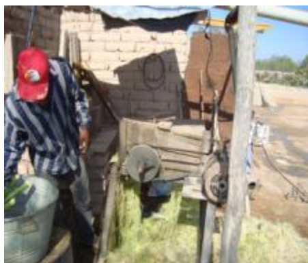
Fotografía Implementación tecnológica para el tallado mecánico para la obtención de ixtle de lechuguilla en greña
