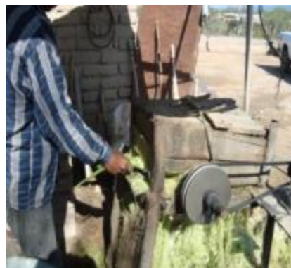
Fotografía Tallado manual y mecánico del agave de lechuguilla para la obtención de ixtle de lechuguilla en greña
