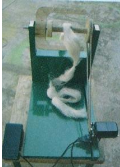
Fotografía . Máquina hiladora de fibra de Maguey con motor eléctrico, Cardonal, Hidalgo.
