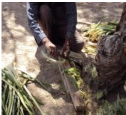
Fotografía Tallado manual y mecánico del agave de lechuguilla para la obtención de ixtle de lechuguilla en greña
