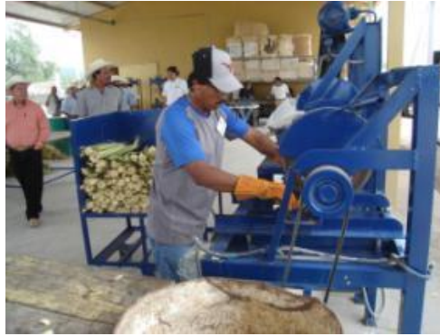
Fotografía . Tallado mecánico del Agave Lechuguilla en el altiplano potosino.
