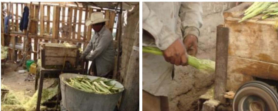
Fotografía . Máquina talladora de Agave Lechuguilla para obtención de Ixtle Mazapil, Zacatecas.
