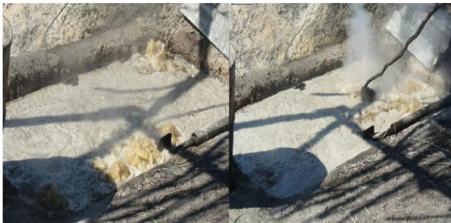
Fig. 1: Obtención de la cera de candelilla mediante la ebullición con ácido sulfúrico.
