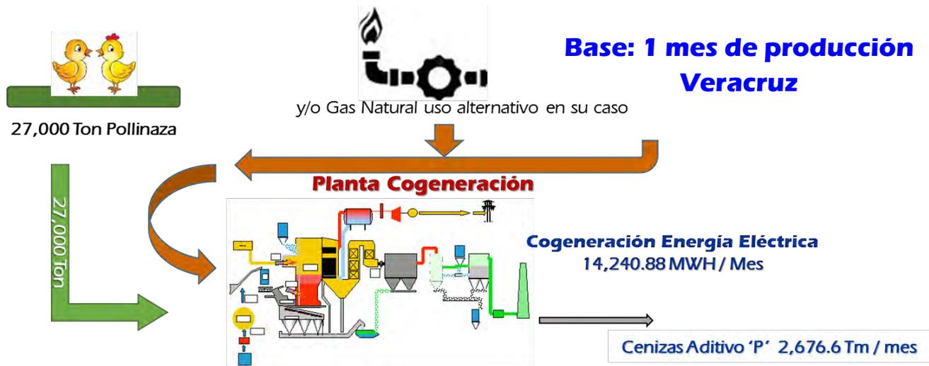
Gráfico 2.- Esquema de arreglo planta para Cogeneración eléctrica
