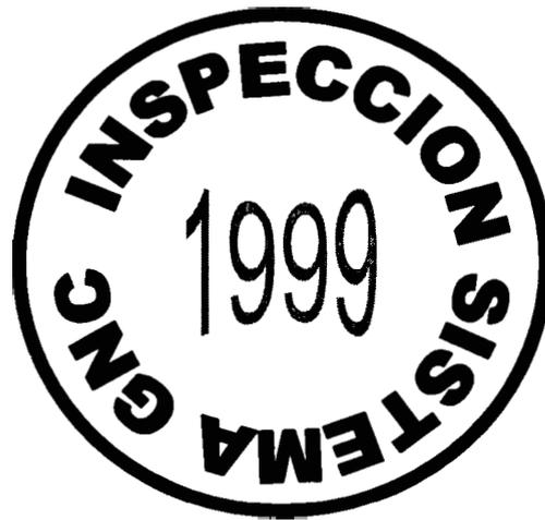
**Figura.-** 13.-Etiqueta de inspección exterior visual de los cilindros y sujeción una vez al ario En el anverso llevara código de barras indicando el perito que hizo la inspección. La cual debe ser otorgada por la autoridad competente
