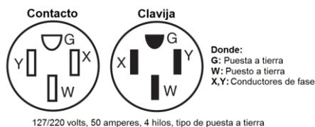
**Figura 550-10 (c).- Configuraciones de contacto y clavija de 220Y/127 volts, 50 amperes, 3 fases, 4 hilos, con conductor puesto a tierra, para uso con cordones de alimentación en casas móviles y sus estacionamientos.**
