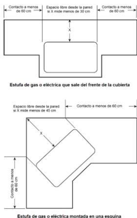
**Figura 210-52(c)(1).**- Determinación del área por detrás de una estufa, una parrilla montada en la cubierta o un fregadero
