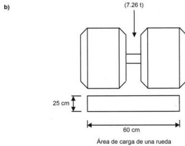
**Figura 923-16.- Características del vehículo para determinar la carga dinámica**
