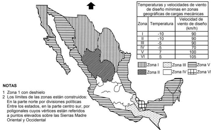
Figura 922-82.- Cálculo de cargas mecánicas
