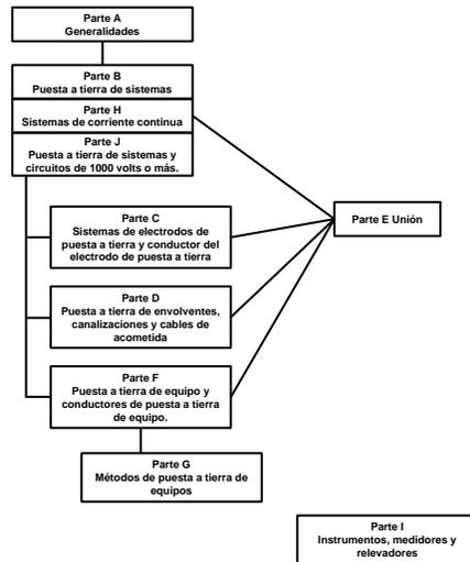
Figura 250-1.- Puesta a tierra y unión.
