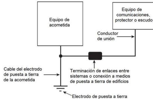
**NOTA:** Figura 800(b). Ejemplo del uso del término Conductor del Electrodo de Puesta a Tierra utilizado en una instalación de comunicaciones.
