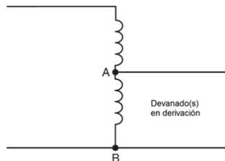
**Figura 450-4.- Autotransformador**
