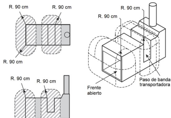
**Figura 516-5(d)(2).- Lugares de Clase I, División 2; de Clase I, Zona 2; de Clase II, División 2 o de Zona 22, adyacentes a un recinto o una cabina del rociado cerrados por arriba, abiertos por la cara o abiertos por el frente.**
