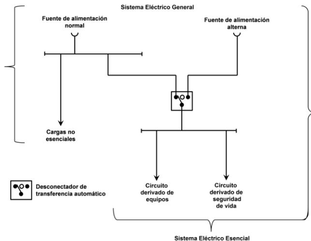
**Figura 517-41(b).- Requisito mínimo un desconector de transferencia para establecimientos de atención de enfermería y de atención limitada, para una demanda de hasta 150 kVA de los circuitos derivados de seguridad de vida y de equipos.**
