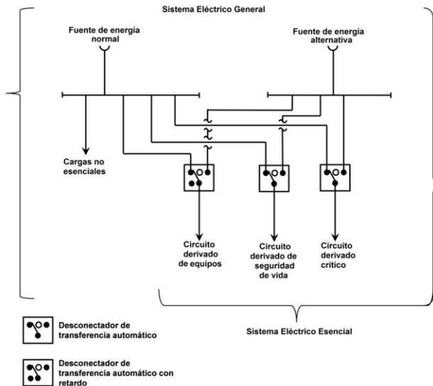
**Figura 517-30 (a).- Requisito mínimo de tres desconectores de transferencia para hospitales y establecimientos para la atención médica de pacientes ambulatorios, con una demanda máxima superior a 150 kVA de la carga conectada a los tres circuitos derivados.**
