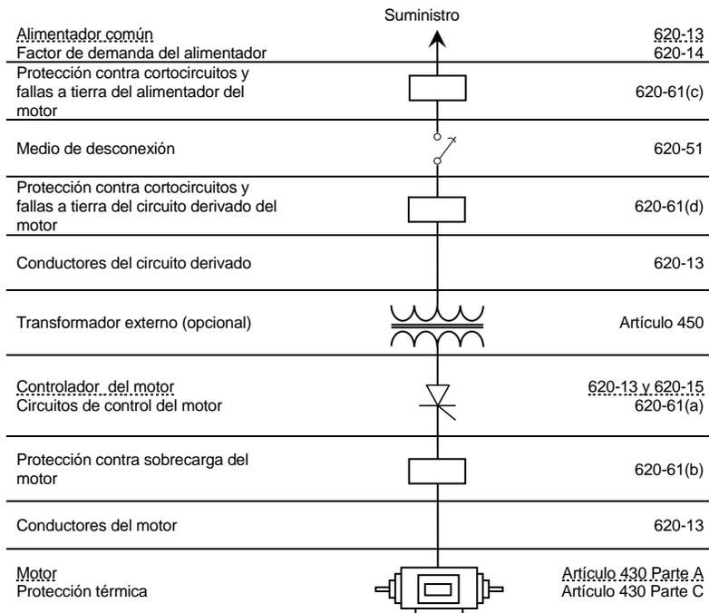
Figura 620-13.- Diagrama unifilar
