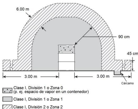
**Figura 516-4.- Clasificación eléctrica de área para actividades con líquidos Clase I alrededor de contenedores abiertos, contenedores de suministro, recipientes de basura, limpiadores de pistolas de pulverización, y unidades de destilación de disolventes**
