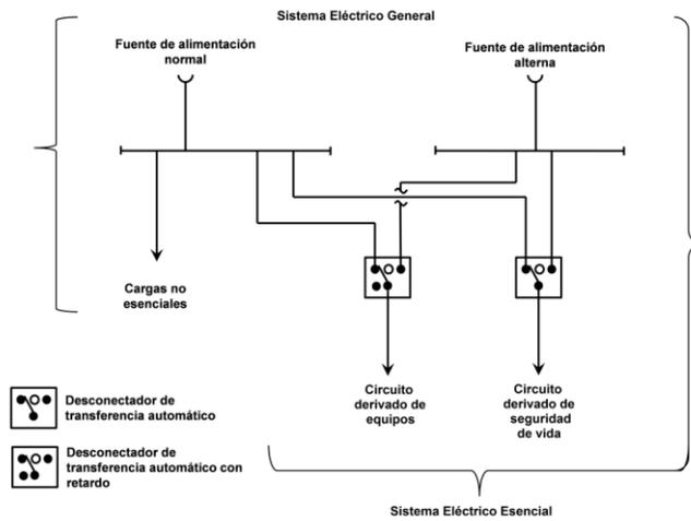
**Figura 517-41(a).- Requisito mínimo de dos desconectores de transferencia para establecimientos de atención de enfermería y de atención limitada, para una demanda superior a 150 kVA de los circuitos derivados de seguridad de vida y de equipos.**
