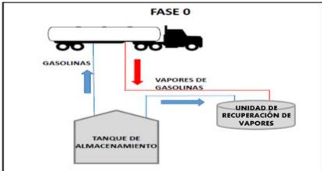
Figura 6. Fase 0 del Sistema de Recuperación de Vapores
