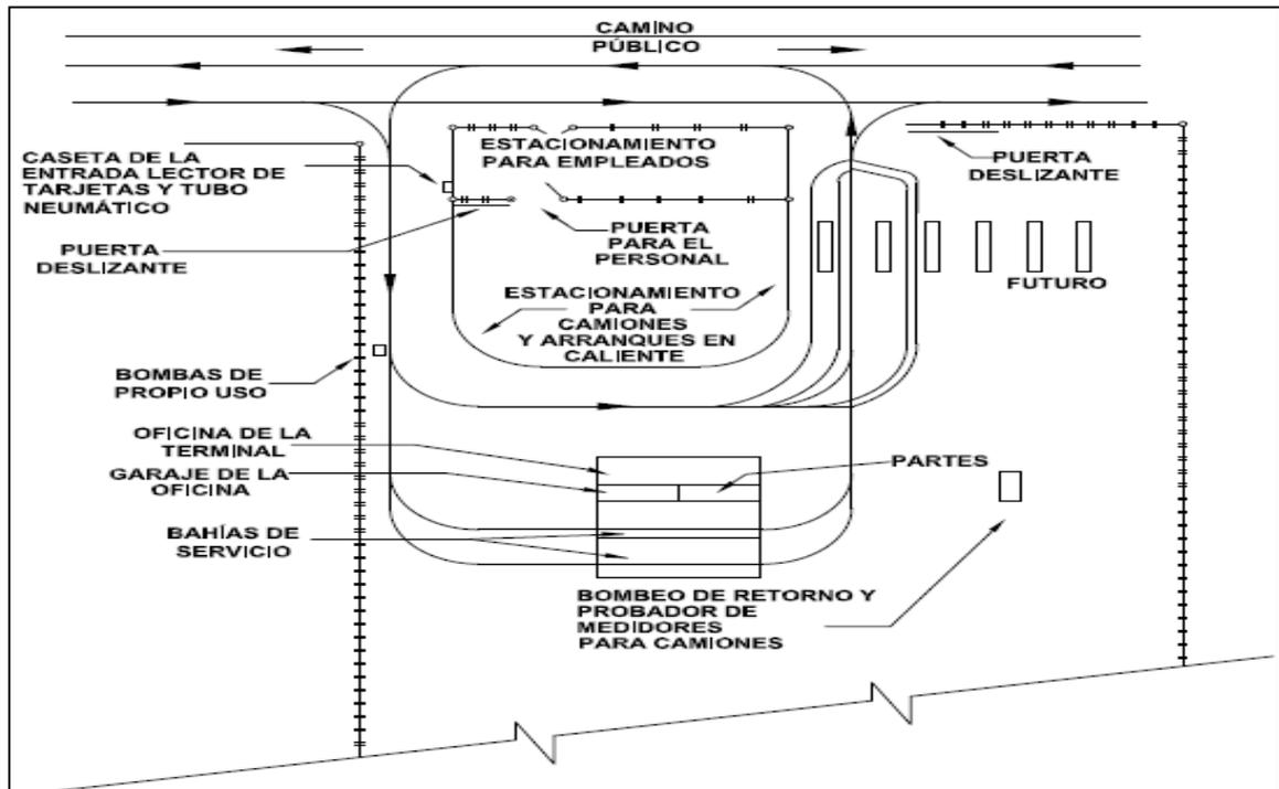
Figura 5. Distribución de patio de carga de Auto-tanques con estacionamiento interno
