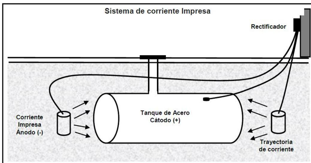
Figura 2. Sistema de protección catódica por corriente impresa
