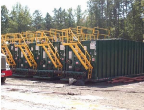
Figura 6.5. Tanques de almacenamiento de agua. Fuente: ALL Consulting (2008)
