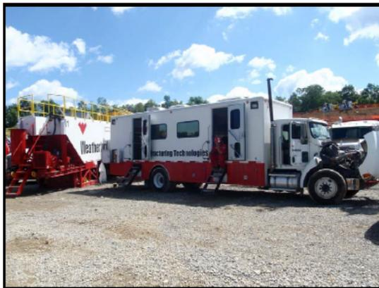
Figura 6.9. Equipos de monitorización móviles (“Technical monitoring vehicle”, TMV) son utilizados para supervisar y controlar todas las operaciones relativas a la explotación de gas no convencional. La figura procede de la explotación de la Formación Marcellus Shale.
