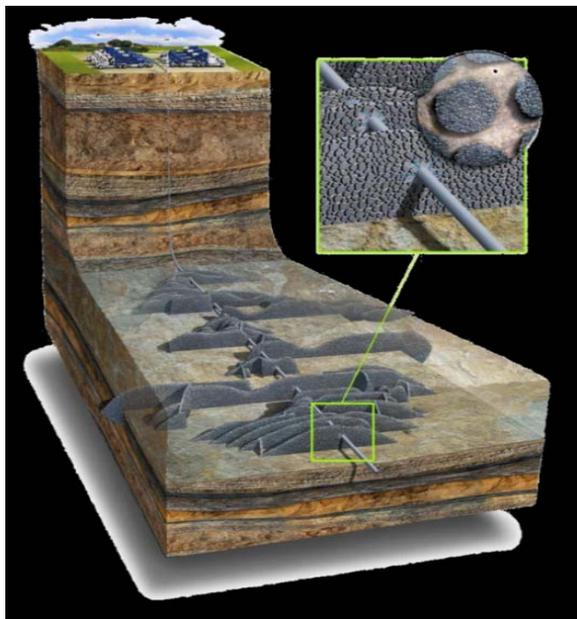
Figura 3.10. Dibujo de la disposición geométrica de una serie de fracturaciones artificiales. Observar que siempre son sub-verticales. Sarmiento 2012
