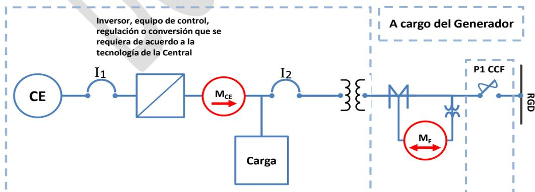
(c) **Esquemas de interconexión 7, 8 y 9:** El medidor de facturación  $M_{CE}$ , mide la Generación Neta de la Central Eléctrica entregada al circuito de distribución.
