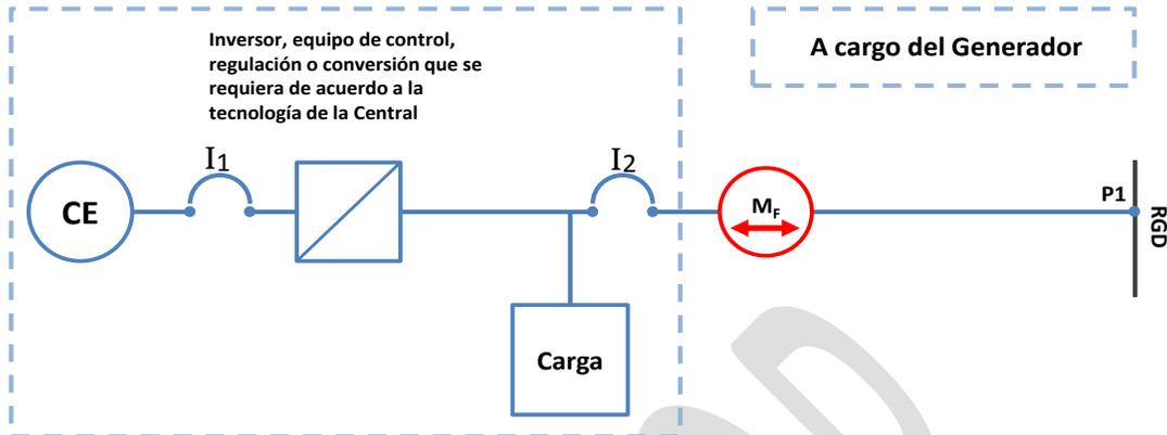
Figura 3.2 Esquema de interconexión 2 para Centrales Eléctricas menores o iguales que 250 kW en Media Tensión con Centros de Carga.
