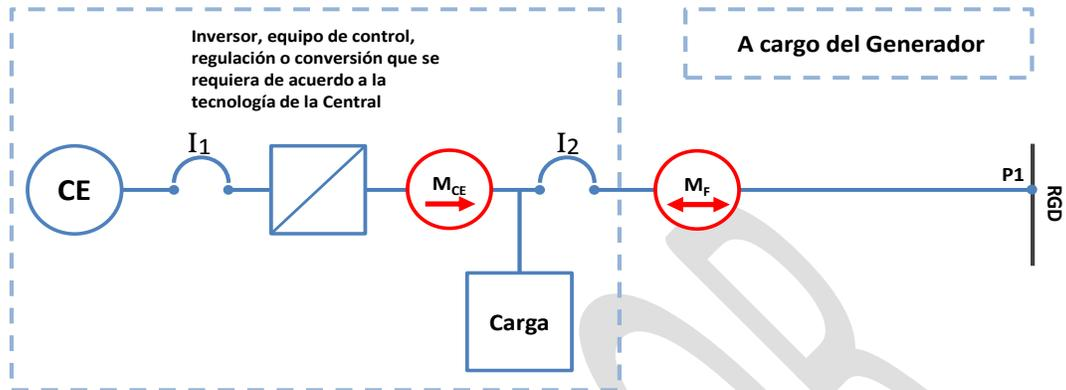
Figura 3.5 Esquema de interconexión 5 para Centrales Eléctricas menores o iguales que 250 kW en Media Tensión con Centros de Carga.
